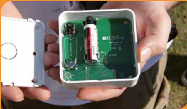
Parameter zentral aufgezeichnet und überwacht werden. Zum Einsatz kommt hier die LoRaWAN-Technologie (d.h. Long Range Wide Area Network), die energieschonend und zuverlässig arbeitet. Diese digitale Technik wird bereits seit einiger Zeit im Riesenschildkrötenhaus sowie in den Afrika- und Australien-Großterrarien eingesetzt.
